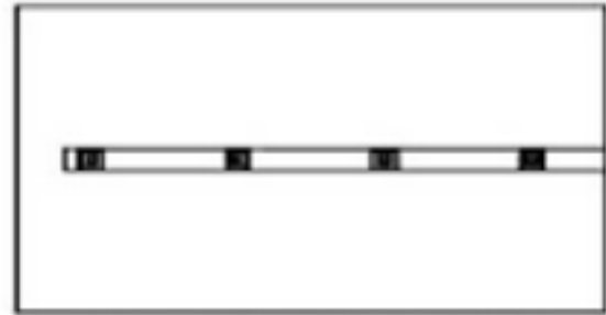
No es correcta la forma de distribución del aire
